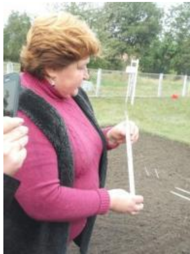
Термометри для вимірювання температури на глибині 10 см, 20 см та на поверхні ґрунту
