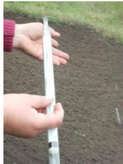
Термометри для вимірювання температури на глибині 10 см, 20 см та на поверхні ґрунту
